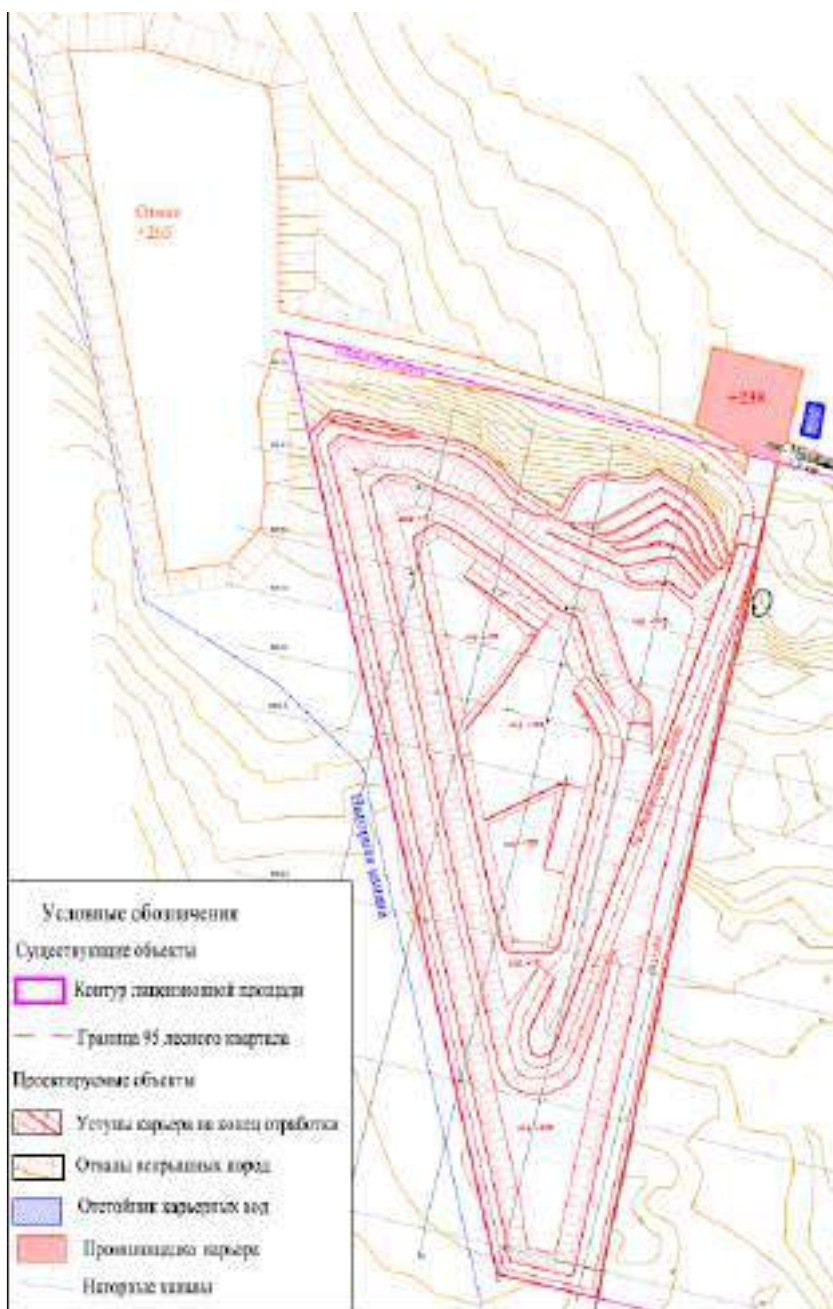
Рисунок 2.1 – Ситуационная схема отработки месторождения Восточный борт карьера, включая защитную минерализованную полосу,
